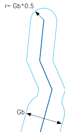
Konstruktions-skizze mit abgerundetem Bachursprung und Übergang zweier unterschiedlicher Gewässerräume
